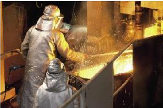
Los módulos y las celdas se introducen en un horno de fundición a alta temperatura ( $>1400\text{ }^\circ\text{C}$ ) sin necesidad de un tratamiento previo.
